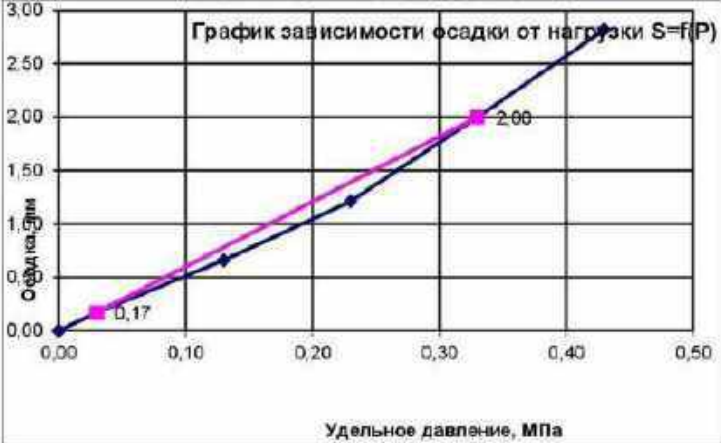
График зависимости осадки от нагрузки
