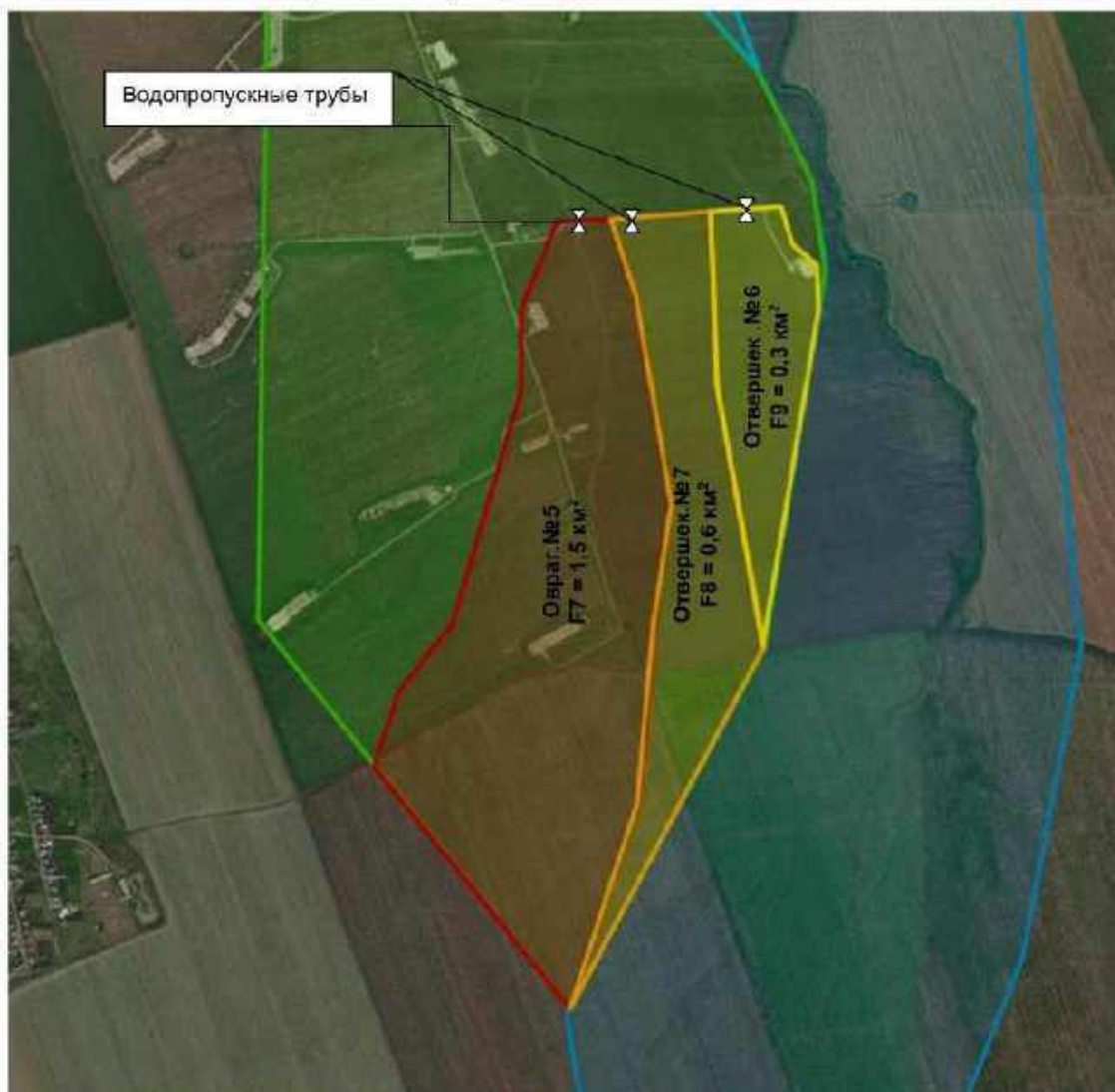
Рисунок. 7.9 Схема водосборной площади исследуемой территории
